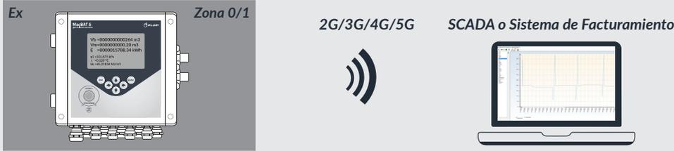
2. *Lectura remota de datos: conexión a través de interfaces de comunicación INT-S3 y controlador RTU de forma independiente*
