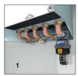
El desfangador cód. 545105 y 545205 se utiliza cuando las conexiones de pared no están alineadas a las conexiones en la caldera (2 y 3), o cuando se necesita un espacio de maniobra mayor que aquel disponible debajo de la caldera. Las conexiones se realizan entonces con tubos flexibles de acero inoxidable.
