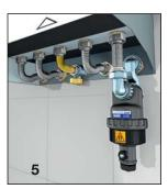
El desfangador cód. 545455 y 545255 tiene una configuración específica para la instalación con calderas Vaillant con conexiones horizontales de plantilla en línea (cód. 545455) y con conexiones horizontales de plantilla W invertida (cód. 545255).
