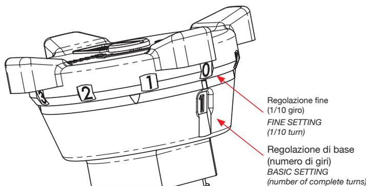
Dato i valori di portata e la perdita di carico richiesta per il bilanciamento, ricavata dal diagramma di regolazione la corrispondente posizione di apertura, per predefinitare la valvola procedere come segue:
