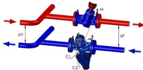
Possono essere montate indifferenteemente sul ramo di alimentazione e di ritorno. Il DN 50 presenta attacchi filettati F/F, per installazione tra flange può essere equipaggiato con flange riportate. Adatte per flange PN 16 e ANSI 150.
