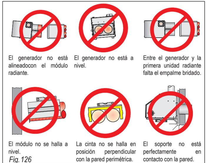
El generador no está alineado con el módulo radiante.
