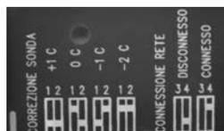
F - Diagrama de corrección de la sonda
