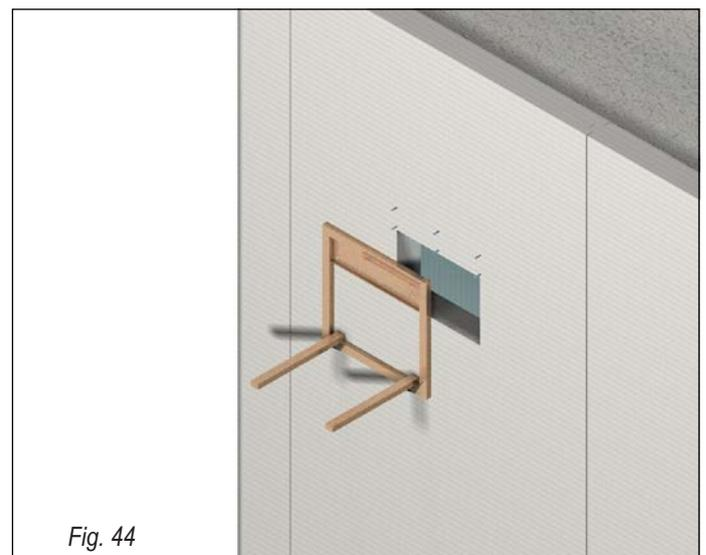
Fijar las lamas con las barras fileteadas a través de tuerca y contratuerca M12 como se indica en la fig. 43. Introducir en los orificios del estante las barras fileteadas anteriormente fijadas a la pared como se indica en la fig. 44.
