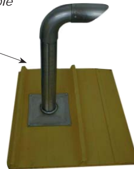
Fig. 34 En la figura de arriba se muestra el detalle del canalón para cubiertas de laminado ondulado, aplicado en chimeneas de descarga y aspiración del Panrad. Cada canalón se realiza a medida y se sella con silicona sobre la cubierta para garantizar una perfecta retención.
