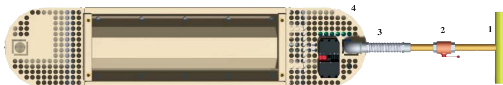
Fig. 18 Esquema de conexión de un panel SUNRAD a la red gas
