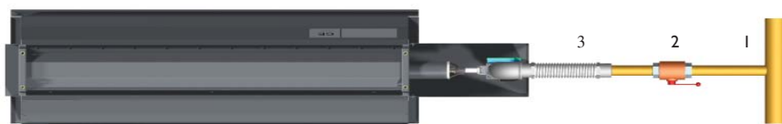
Fig. 12 Esquema de conexión de un panel SUNRAD a la red gas
