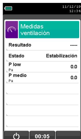
EL DISPOSITIVO SE DETIENE SEGÚN EL PERIODO DE ESTABILIZACIÓN CONFIGURADO, TRAS EL CUAL EJECUTA LAS 3 MEDICIONES ESTABLECIDAS.
