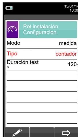
Tipo de cálculo: se puede elegir calcular la potencia térmica mediante la introducción de un caudal, o mediante la lectura del contador (sólo combustibles gaseosos).
