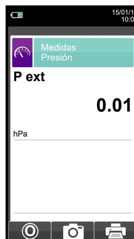
Medida de la presión mediante una sonda de tiro externa.
