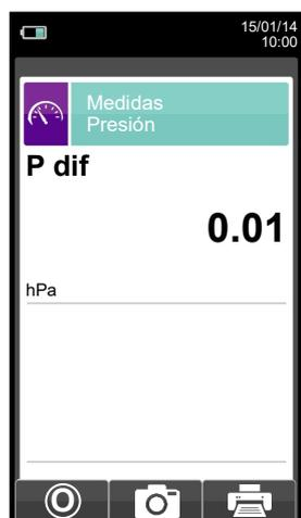
Medida de la presión diferencial mediante el sensor de presión interno.
